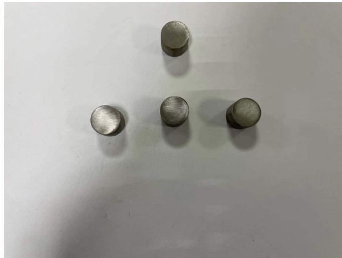
TJA20201110-1005 试验后试块照片(气相缓蚀能力)
