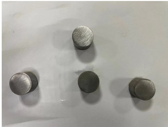
TJA20201101-1257 试验后试块照片 (气相缓蚀能力)
