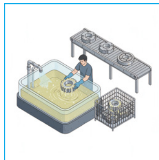
工序间清洗，为后续处理提供临时的防锈保护
